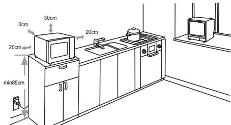
Задняя панель корпуса печи должна быть на расстоянии от стенки не менее 30см, а боковые панели корпуса печи должны быть на расстоянии не менее 20см от стенок.
